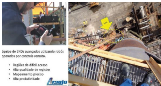
Figura 21 – Acesso remoto do robô de ENDs às regiões de interesse
