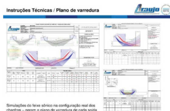
Figura 20 – Simulações do feixe sônico para os ensaios de Phased Array e ToFD que fazem parte da instrução de END
