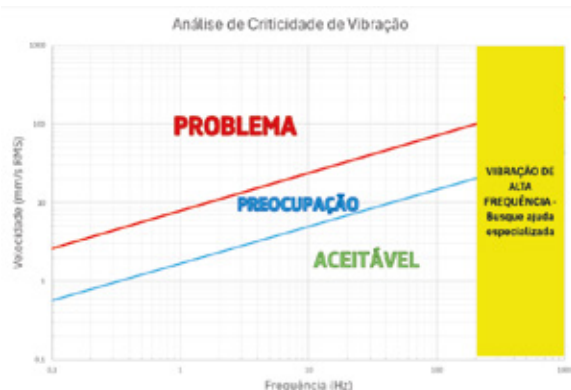
Figura 3 - Representação gráfica das Equações 1 (azul) e 2 (vermelha), e as áreas para a análise de criticidade das vibrações
