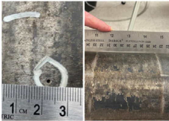
Figura 4 – Fotografias detalhando os furos passantes e as áreas desbastadas que requerem detecção
