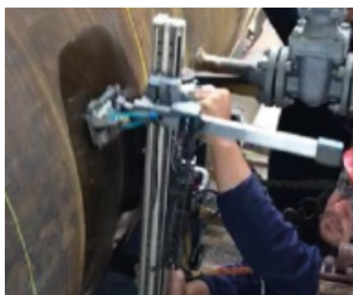
Figura 13 – Dispositivo especial para compensação da variação geométrica dos tampos na varredura ultrassônica C-Scan
