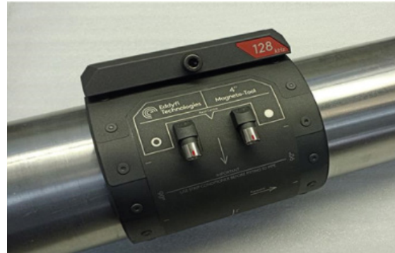
Figura 6 – Ferramenta Magneto para tubo de 100 mm/4 polegadas de diâmetro e frequência de teste de 128 kHz
