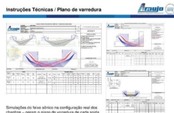
Simulações do feixe sônico na configuração real dos chanfros – geram o plano de varredura de cada solda
