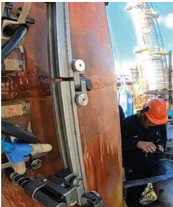
Figura 18 – Exame Phased Array + ToFD robotizado em coluna de processo
