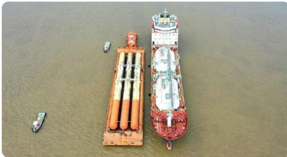
**Figura 13** – Manobra de aproximação para amarração BTS na área de fundeio de Codajás/AM, transferência de GLP (cedida por Transpetro)
