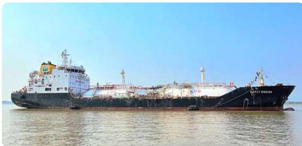
**Figura 11** – Arranjo de defensas montado para operação BTS na área de fundeio de Codajás/AM (cedida por Transpetro)
