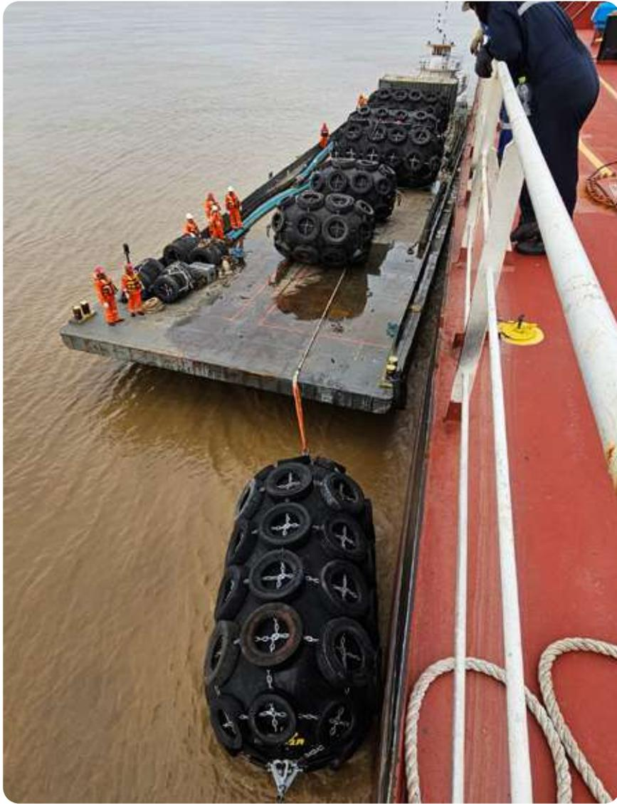
**Figura 12** – Arrumação do arranjo de defensas para operação STB na área de fundeio (cedida por Transpetro)
