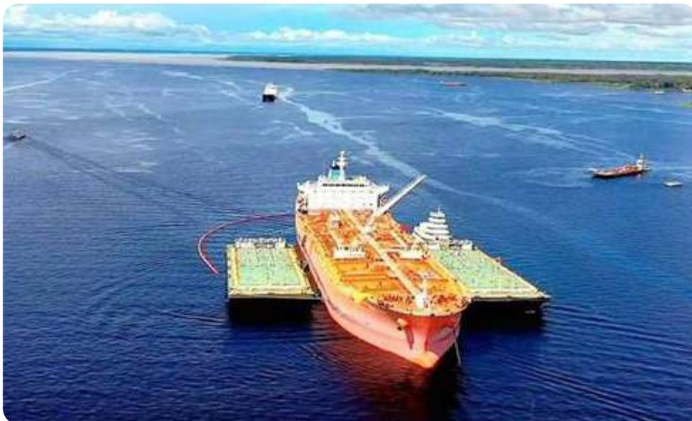
**Figura 08** – Operação BTS de transferência simultânea na área de fundeio de Manaus – AM (cedida por Transpetro)
