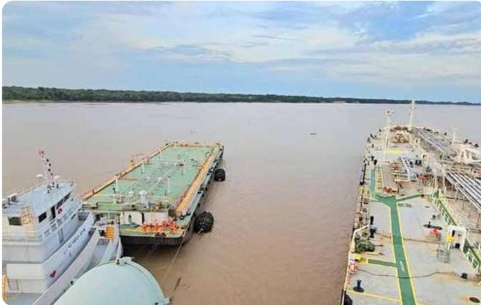
**Figura 15** – Defensas primárias posicionadas na balsa tanque manobrando a contrabordo do navio fundeado em Coari/AM (cedida por Transpetro)
