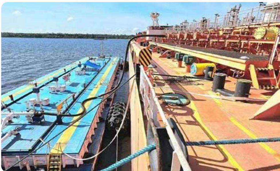
**Figura 07** – atracação STB utilizando cabo de amarração do navio aliviador (cedida por Transpetro)
