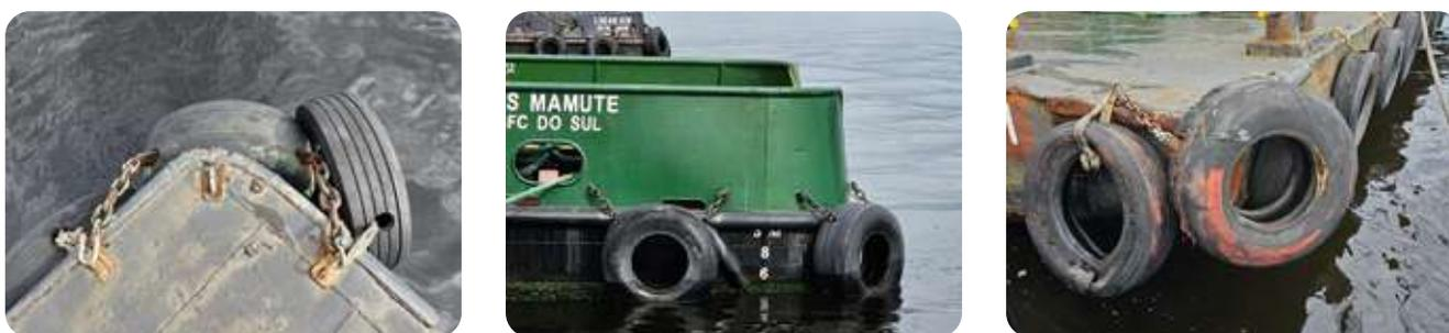
**Figura 14** – Defensas fixas e temporárias de pneus nas quinas dos empurradores e balsas tanque (cedida por Transpetro)
