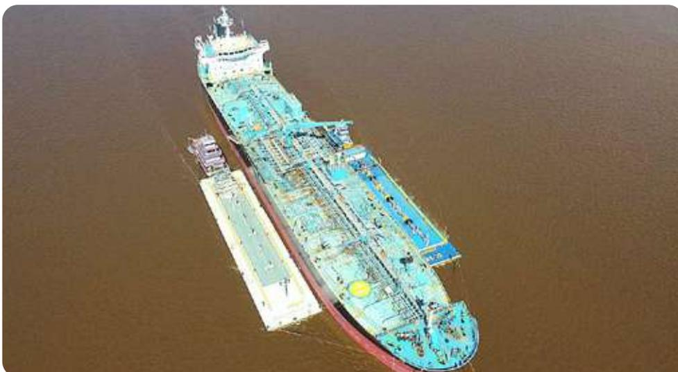
Figura 16 – Navio fundeado com duas âncoras, boreste à pé de galo, realizando operação STB (cedida por Transpetro)
