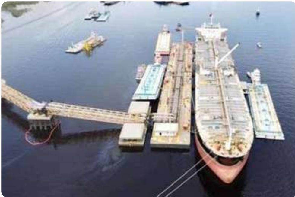
**Figura 17** – Operação STB com navio atracado em cais flutuante (cedida por Atem Distribuidora).
