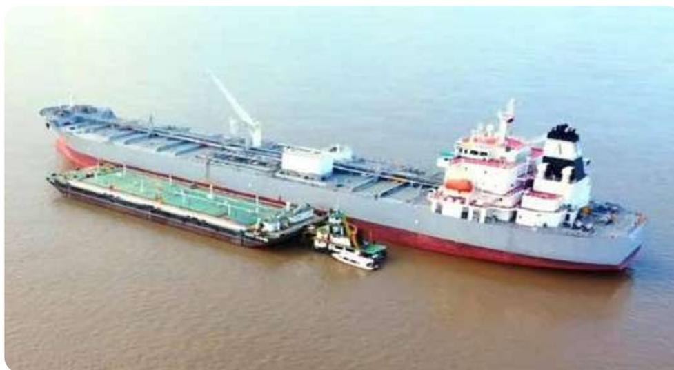
**Figura 28** – Mangotes sendo suportados pelo guindaste do navio e pau de carga da balsa tanque (cedida por Transpetro)
