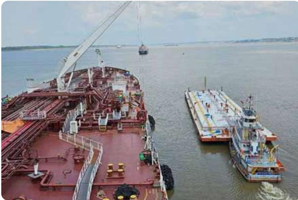
**Figura 10** – Manobra de aproximação entre navio e comboio com balsa tanque (cedida por Transpetro)
