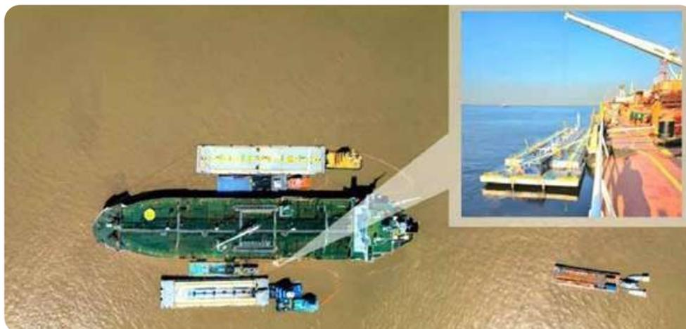
**Figura 04** – atracação STB utilizando cabo de amarração do navio aliviador (cedida por Transpetro)
