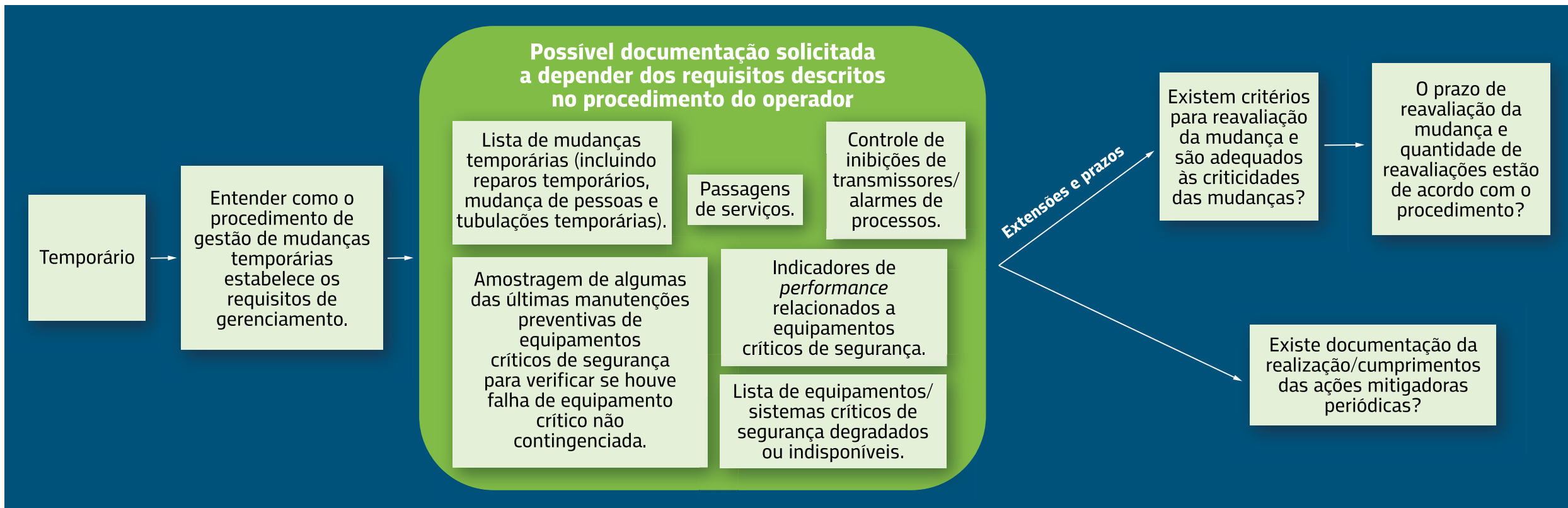
Figura 38 – Trilha de auditoria para mudanças temporárias, incluindo possível documentação a ser solicitada
