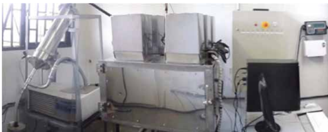
Figura 5 – Unidade experimental composta por micro-ondas, condensador e painel de controle
