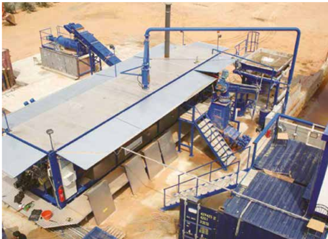
Figura 3 – Modelo de unidade de dessorção térmica a baixa temperatura
