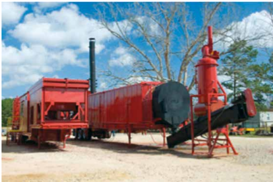
Figura 4 – Modelo de unidade de dessorção por calor indireto
