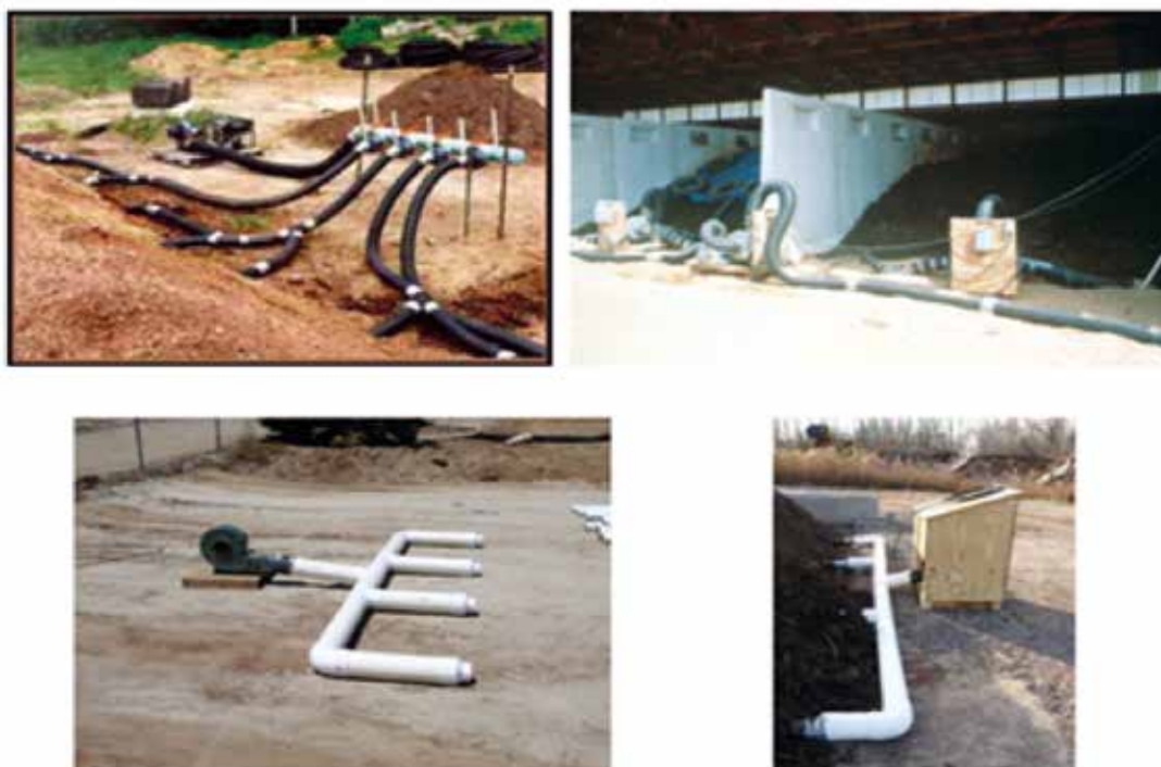
Figura 13 – Ilustrações do sistema de pilhas estáticas aeradas
