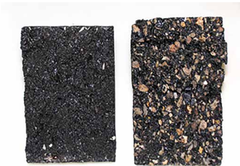
Figura 8.6 – Amostra de concreto asfáltico sem danos devido à umidade (esquerda) e com danos (direita), com inúmeros agregados descolados do ligante
