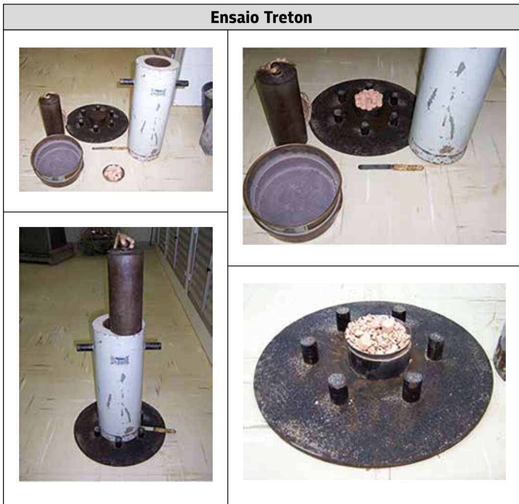
Figura 5.3 – Ensaio Treton: equipamento e passos do ensaio
