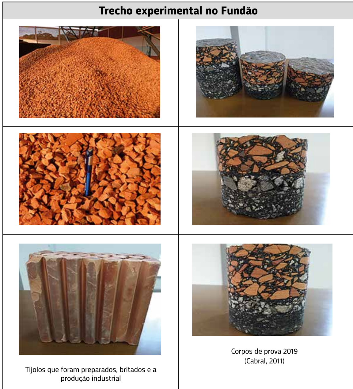
Figura 3.12 – Agregados de argila calcinada e corpos de prova do trecho experimental no campus Fundão da UFRJ (RJ)
