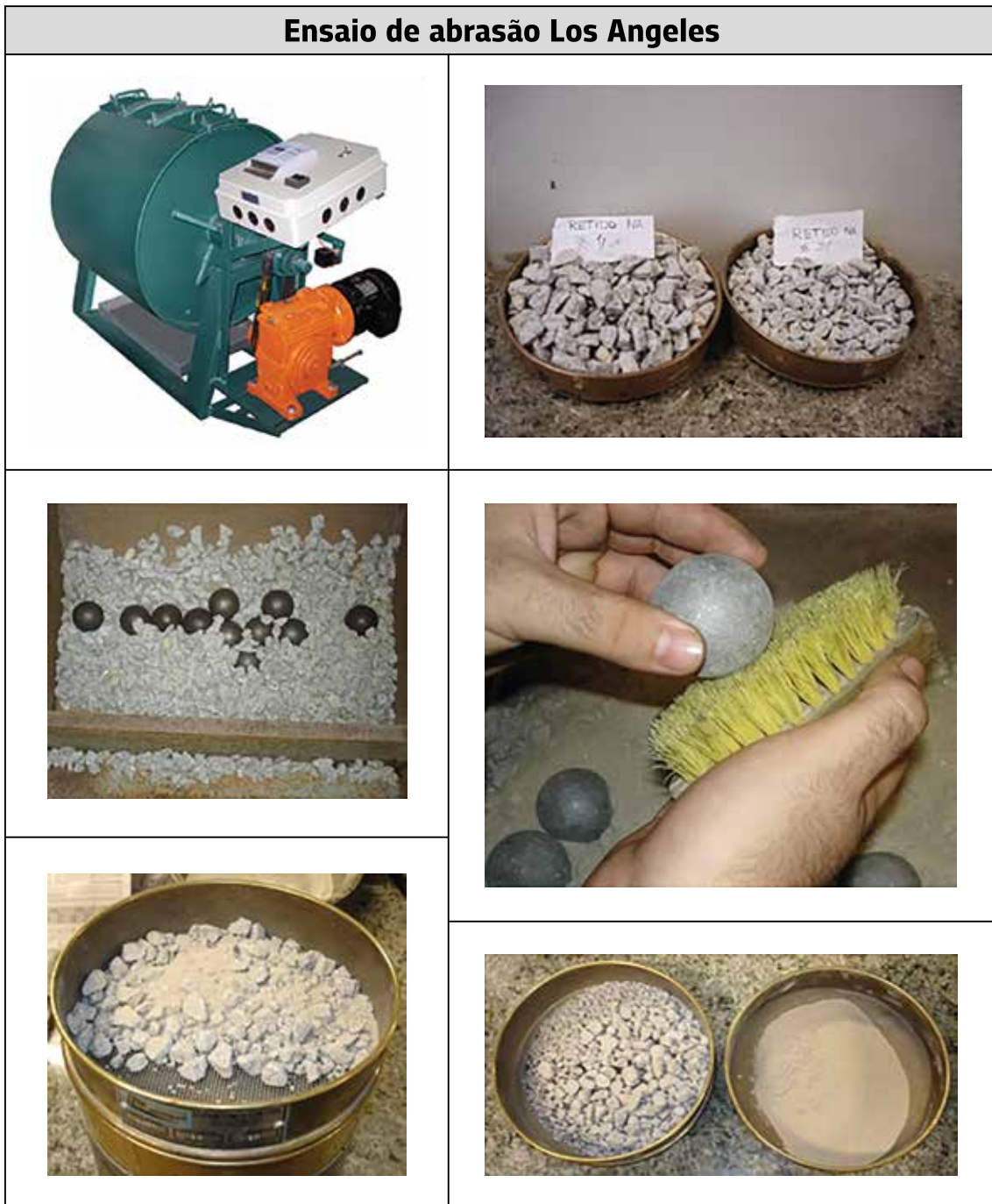
Figura 5.1 – Exemplo de equipamento Los Angeles e passos do ensaio
