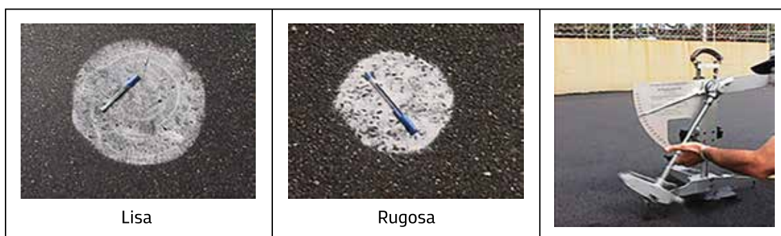
Figura 8.5 – Métodos da mancha de areia e do pêndulo britânico de avaliação de macro e microtextura de uma superfície asfáltica
