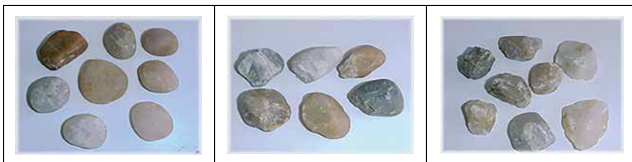
Figura 4.6 – Exemplos de agregados naturais com diferentes características de textura superficial e faces fraturadas
