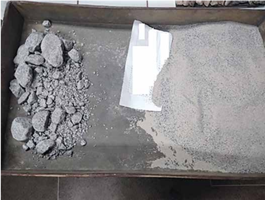
Figura 5.2 – Agregado após abrasão Los Angeles, faixa A, LA = 83% (material indesejado)
