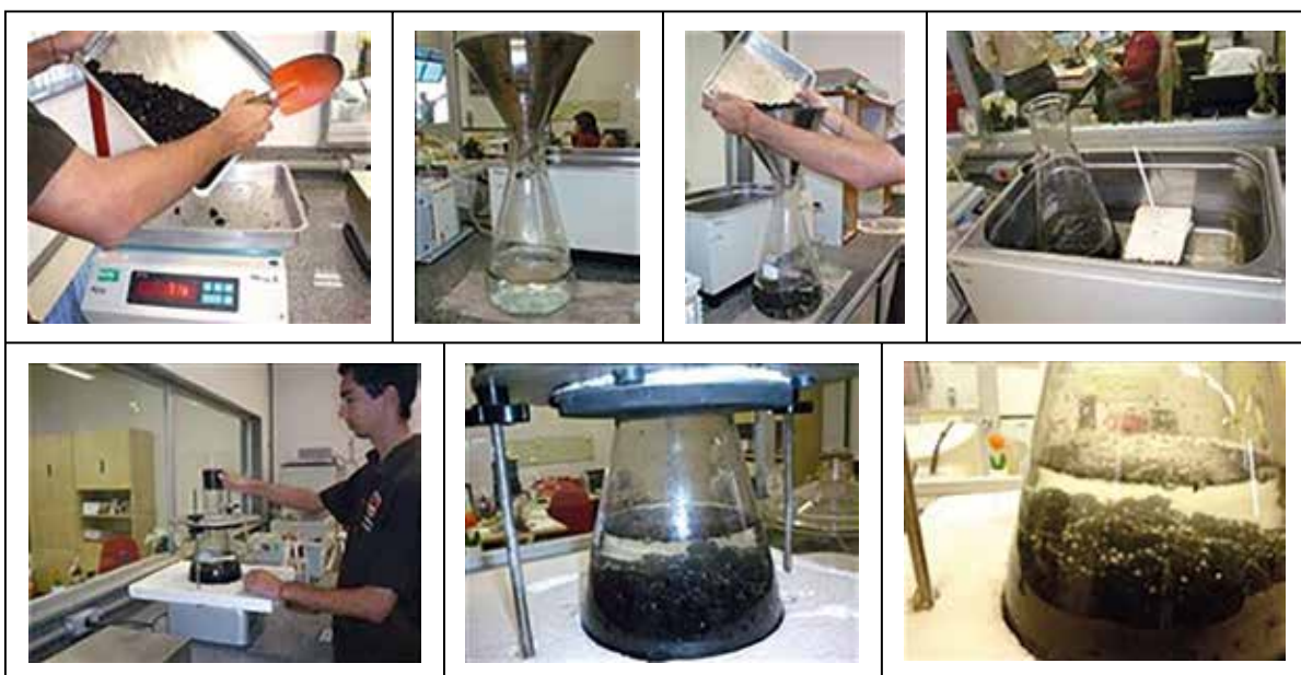
Figura 4.9 – Passos do ensaio de densidade máxima medida da mistura asfáltica não compactada
