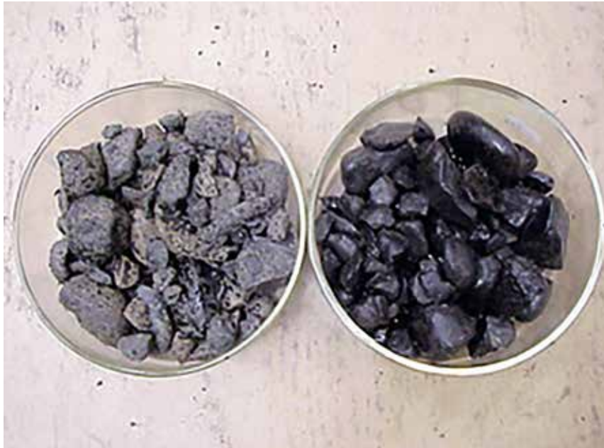
Figura 8.7 – O agregado à esquerda apresenta descolamento severo do ligante e o mesmo agregado à direita com 0,5% de agente melhorador de adesividade
