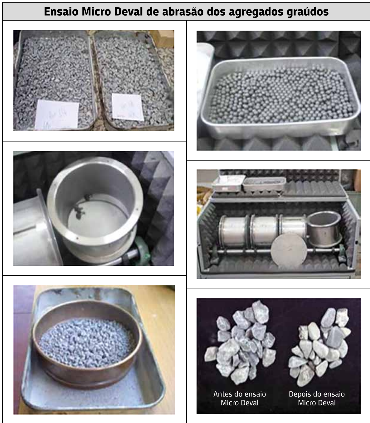
Figura 5.6 – Equipamento para o ensaio Micro Deval de abrasão dos agregados graúdos
