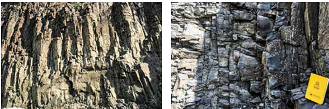
Figura A1.1 – Padrão colunar do basalto e o persistente diaclasamento observável no material fresco por toda a frente de lavra
