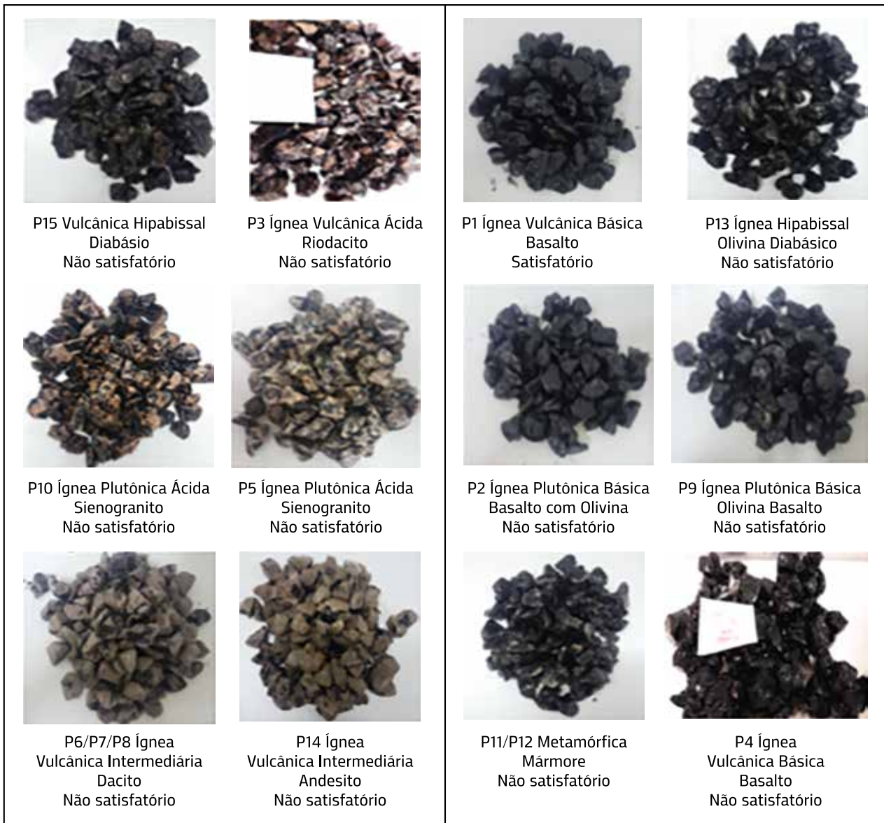
Figura 4.11 – Exemplos do resultado do ensaio de adesividade visual de agregados do RS
