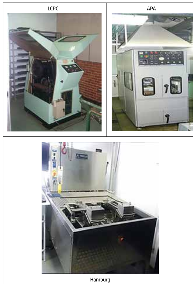
Figura 8.15 – Equipamentos de ensaio de deformação permanente de misturas asfálticas do tipo simulador de tráfego de laboratório
