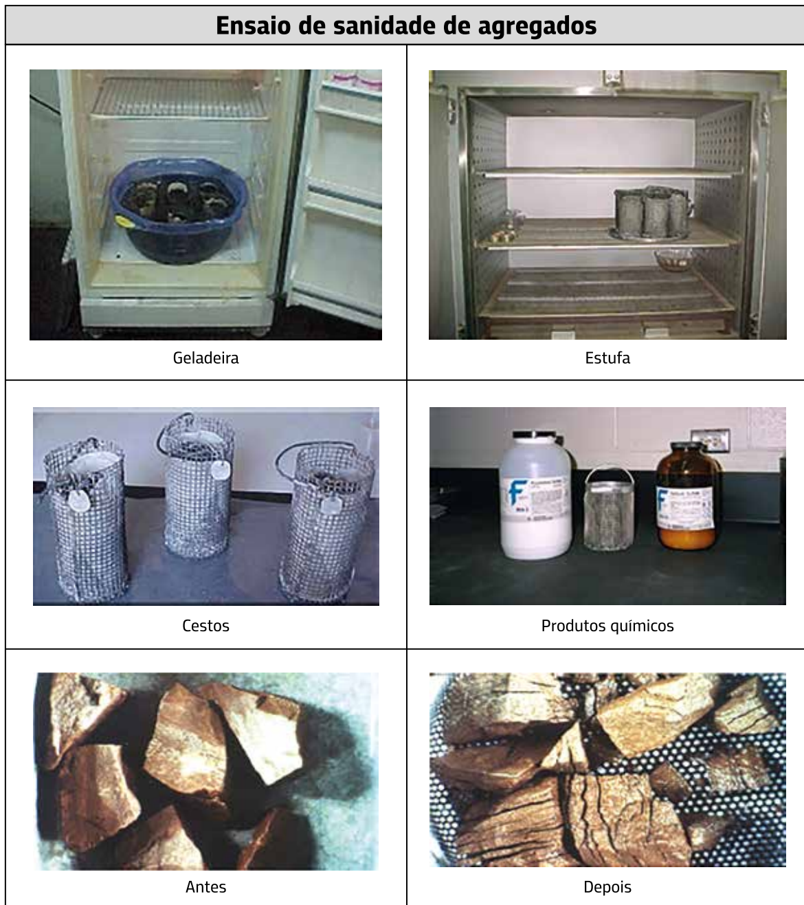
Figura 4.14 – Passos do ensaio de sanidade de agregados e produtos usados
