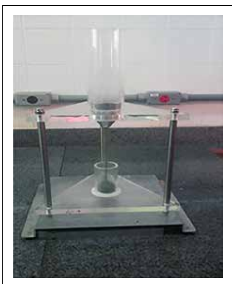
Figura 4.4 – Detalhe do ensaio de angularidade de agregados finos e valores admissíveis
