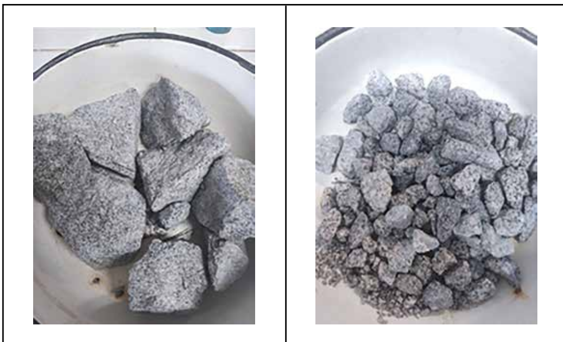
Figura 4.13 – Exemplo da ocorrência de desagregação e fendilhamento do agregado no ensaio de durabilidade (sanidade), com cinco ciclos no sulfato de magnésio
