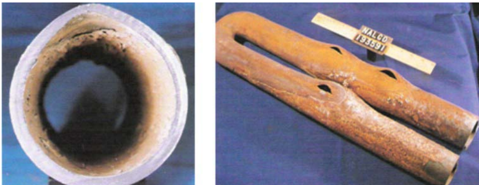
Figura 17 - Tubo de caldeira exibindo "laranjas" (Fonte: Nalco).
