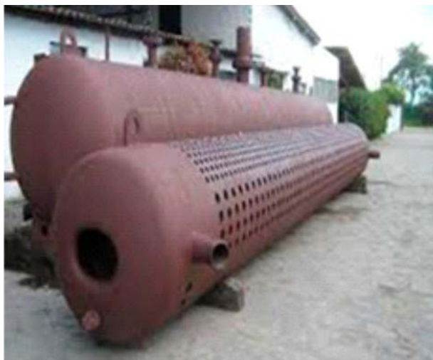
Figura 7 - Tubulões de vapor de caldeira antes da montagem (Fonte: MF Rural).
