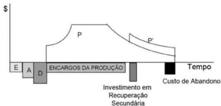
Figura 1: Fluxo de caixa de um projeto de exploração de petróleo, onde E - exploração; A - avaliação; D - desenvolvimento; P - produção. | Fonte: Martins (2015).
