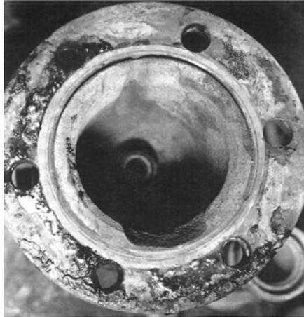
Corrosão ácida em aço carbono por vazamento
