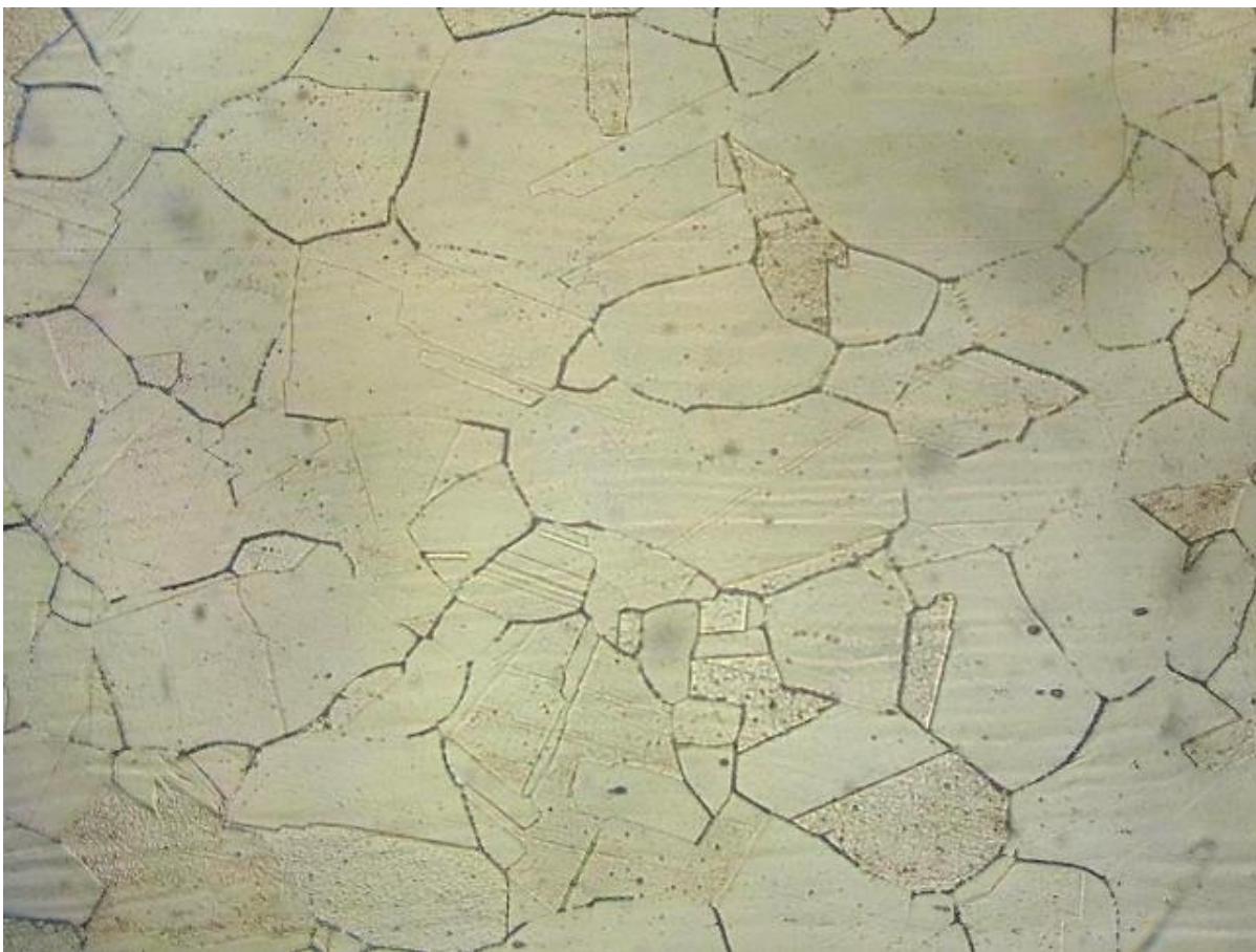
Micrografia, ataque com ácido Oxálico 10%, aumento de 800X
