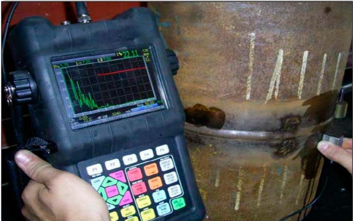
**Figura 10 – Inspeção de Solda com ultrassom.**
