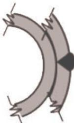
**Figura 11c – Sem uso de Mata-Junta**
