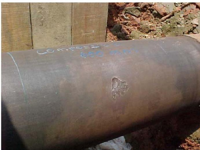
**Figura 7 – Exemplo de tubulação com corrosão externa**
