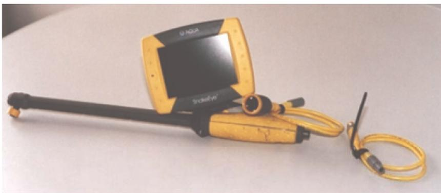
**Figura 9 – Equipamento de endoscopia industrial**
