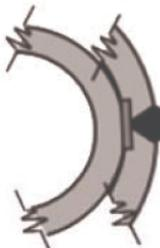
**Figura 11b – Com uso de Mata-Junta com Rebaixo para Encaixe**
