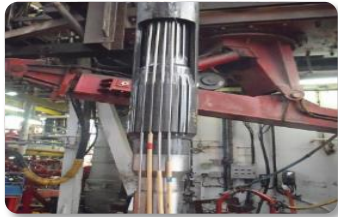
Completação inteligente em águas ultra-profundas, em poços satélites com potencial de incrustação de carbonato de sódio
