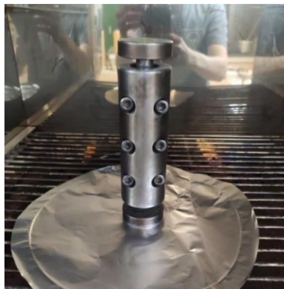
Molde e processo de compactação (Curado et al., 2021)
