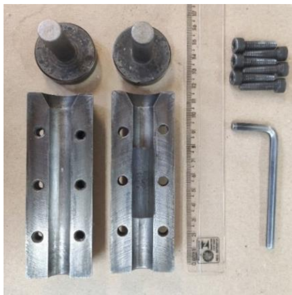
Molde e processo de compactação (Curado et al., 2021)
