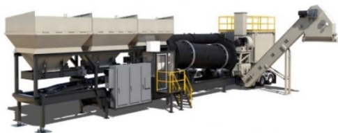
Usina de chassi único Misturador externo até 15% de RAP
