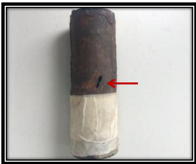
Tubo furado após a Limpeza Química
