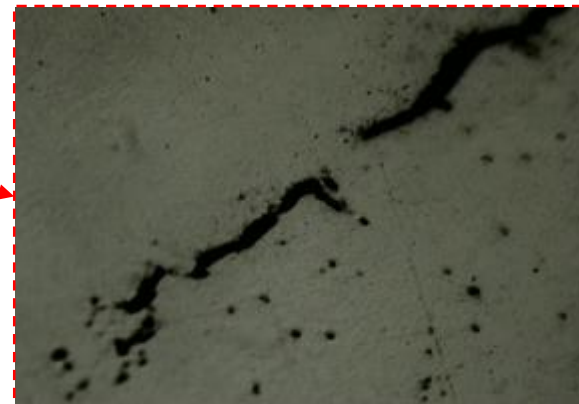
Foto detalhe da extremidade da trinca. Aumento 400X.
