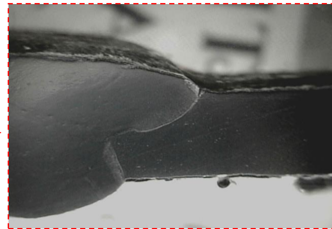
Macrografia da superfície com trinca
