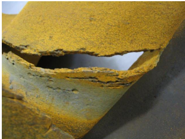
Aspectos da falha e pites de corrosão (LE)
