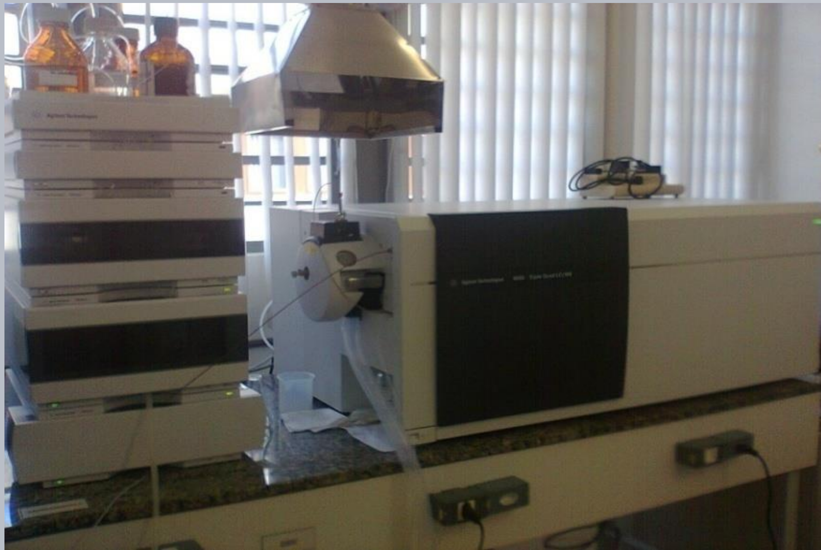
Cromatógrafo Agilent Technologies 1260 Infinity com detector de massa Agilent Technologies 6430 Triplo quadrupolo.
